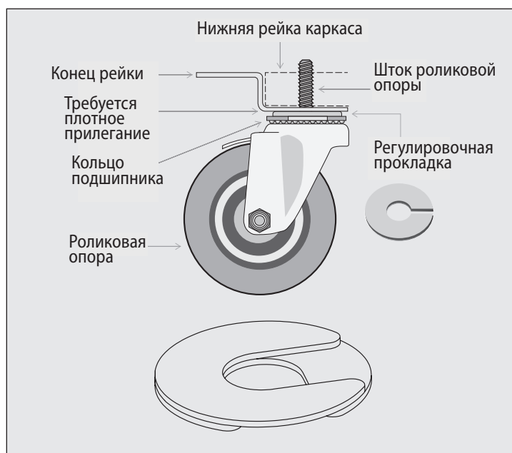
Рис. 4. Роликовая опора со штоком и прокладки. При установке нескольких прокладок следить, чтобы их пазы были смещены относительно друг друга.
