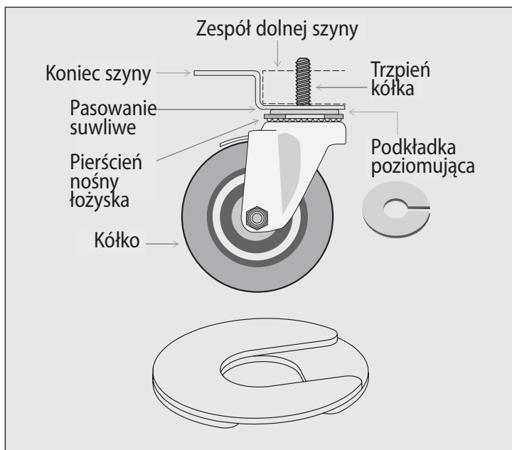
Rys. 4. Trzpień kółka i podkładki. Nałożyć wiele podkładek z przesuniętymi otworami.
