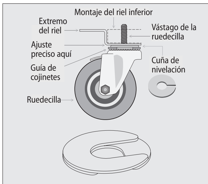
Fig. 4. Ruedecilla y cuñas con vástago. Instale varias cuñas con ranuras desplazadas.
