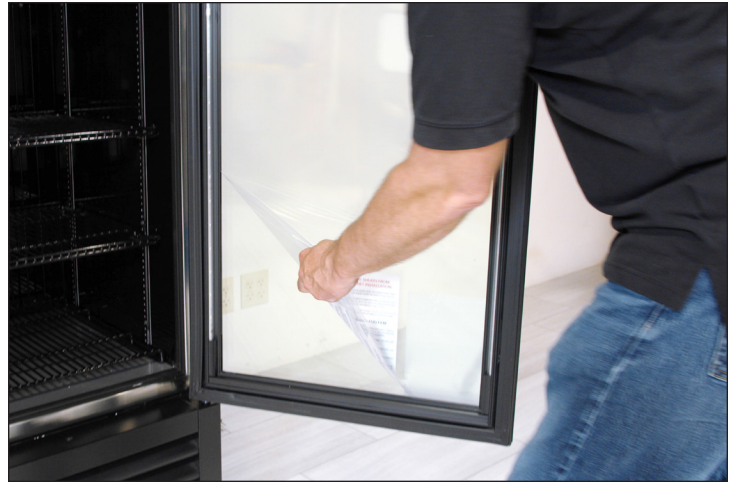
Fig. 1. Jale la película protectora del vidrio interno.
