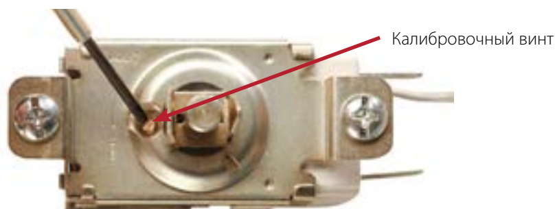
Рис. 1. Расположение калибровочного винта на лицевой поверхности терморегулятора за ручкой.
