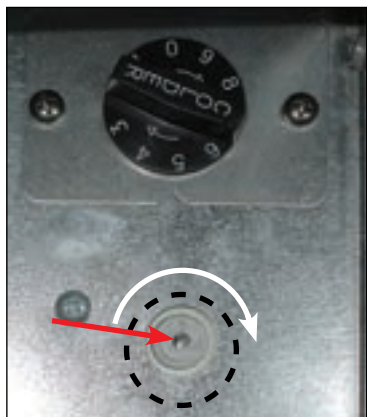
Рис. 2. Повернуть приводной механизм по часовой стрелке до щелчка контактов.
