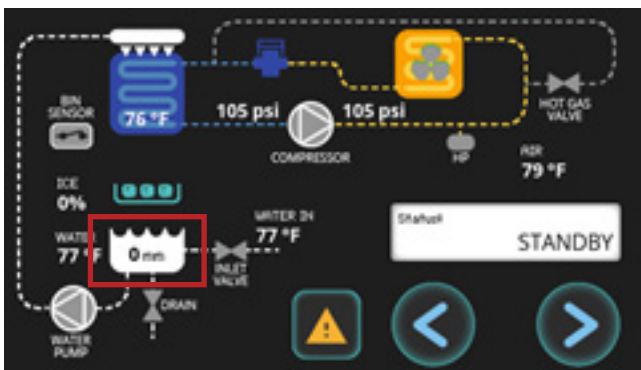
Fig. 1. El nivel del agua marca 0 mm.
