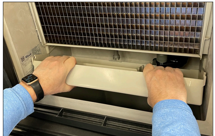
Fig. 5. Inclíne el tanque del colector y luego retírelo.
