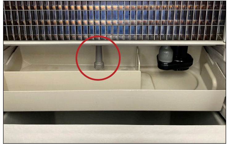
Fig. 3. Ubicación del sensor de nivel de agua
