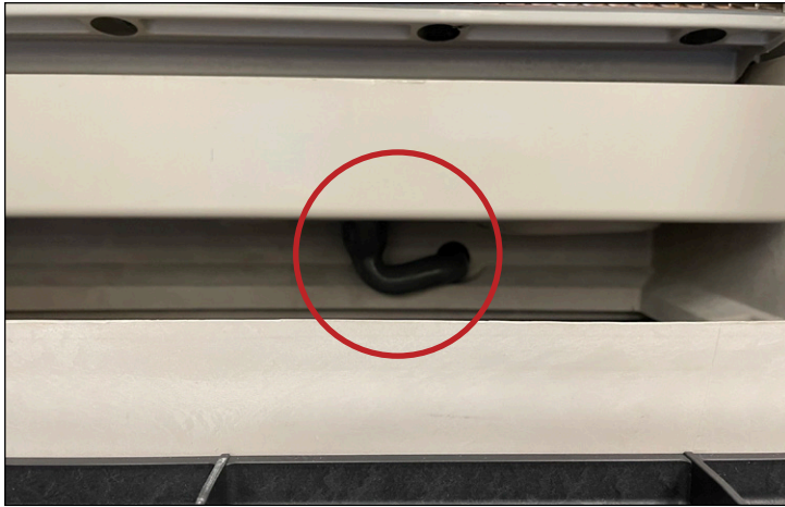
Fig. 2. Ubicaciones del conector de drenaje del colector.
