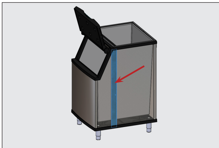
Figure 3. Zone de collage de la coupelle à glaçons extérieure. Autre côté non illustré.
