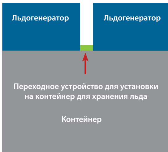
Рис. 2. Льдогенераторы установлены с обеих сторон бункера.
