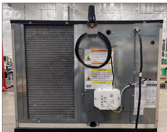
Rys. 3. Zainstalowana na modemie antena. Antena może w rzeczywistości być nieco inna.
