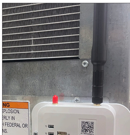
Rys. 3. Zainstalowana na modemie antena. Antena może w rzeczywistości być nieco inna.
