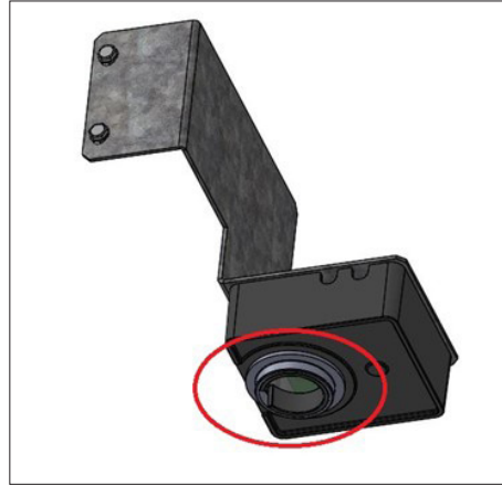
Fig. 2 Ubicazione della lente del sensore per il livello del ghiaccio.
