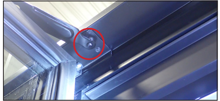
Fig. 5. Ubicación del soporte de transporte del estante. Se muestra un soporte.
