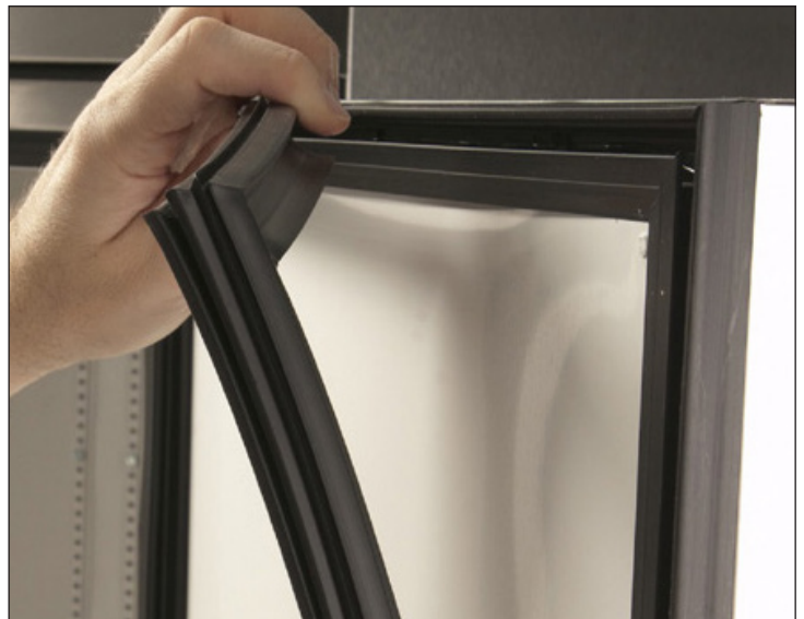
Рис. 2. Потяните за уплотнитель, начав в верхнем углу.
