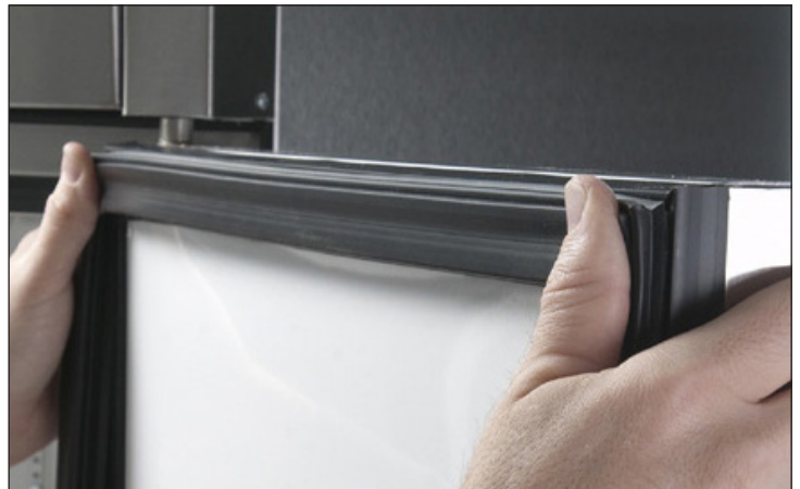
Рис. 4. Обычно можно видеть, как силикон выдавливается из направляющей рядом с уплотнителем. Это указывает на то, что было нанесено достаточное количество силикона.
