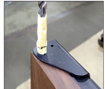
Рис. 9. Сначала просверлите отверстие 3/8". ЗАТЕМ просверлите отверстие 17/64".
