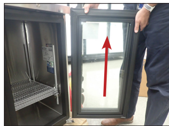
Рис. 2. Поднимите дверь, чтобы извлечь ее из нижней петли.
