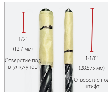
Рис. 8. Обозначьте глубину отверстий на сверлах.
