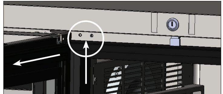
Рис. 2. Демонтируйте верхнюю петлю с устройства.
