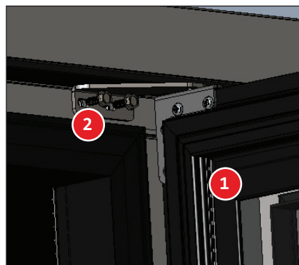
Рис. 10. Смонтируйте верхнюю петлю и дверь.
