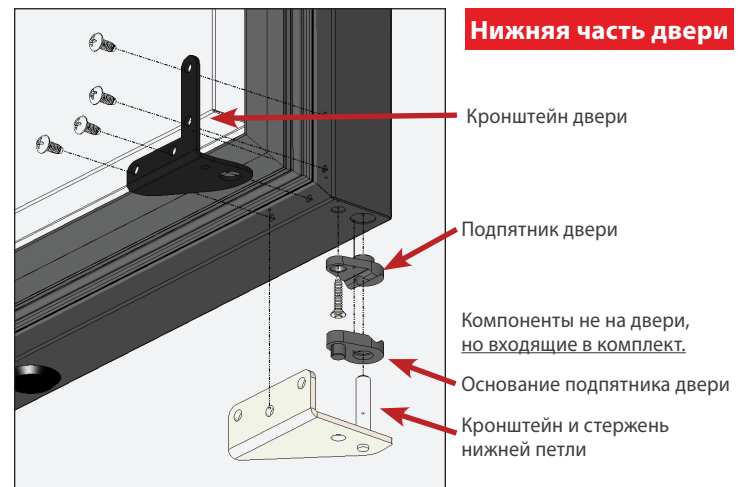
Рис. 4б. Компоненты нижней петли.
