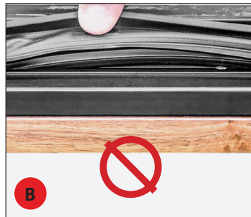
Fig. 12. Tirare la parte laterale della guarnizione per controllarne l'installazione. A: CORRETTA ; il canale della guarnizione NON è visibile. B: SCORRETTA ; il canale della guarnizione è visibile.
