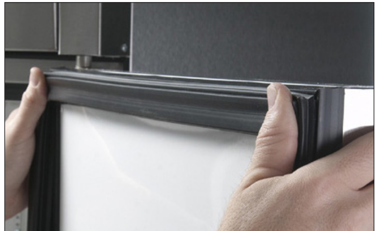
Fig. 4. È comune osservare del silicone che fuoriesce dalla guida di scorrimento, attorno alla guarnizione. Questa è la prova che è stato usata una quantità sufficiente di silicone.
