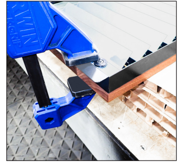
Fig. 2. Centrare la copertura e la griglia negli angoli. Il pannello è leggermente più grande della griglia.
