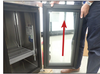
Fig. 2. Sollevare lo sportello per sfilarlo dalla cerniera inferiore.
