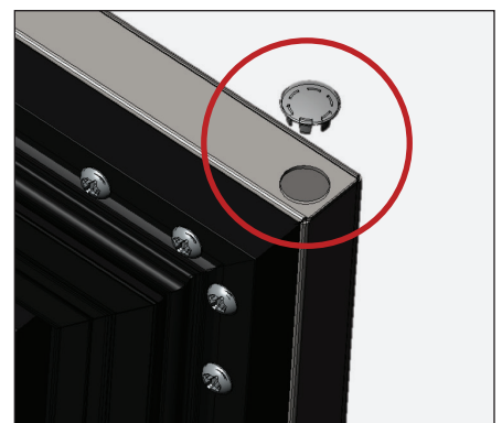
Fig. 11. Installez le cache.
