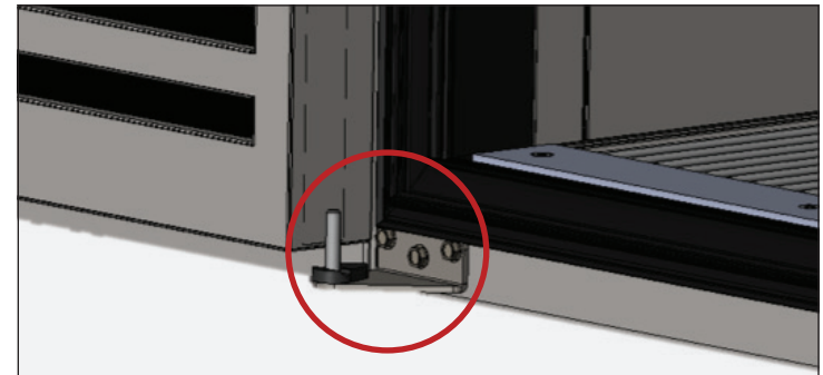
Fig. 3. Soulevez la porte de la charnière inférieure.
