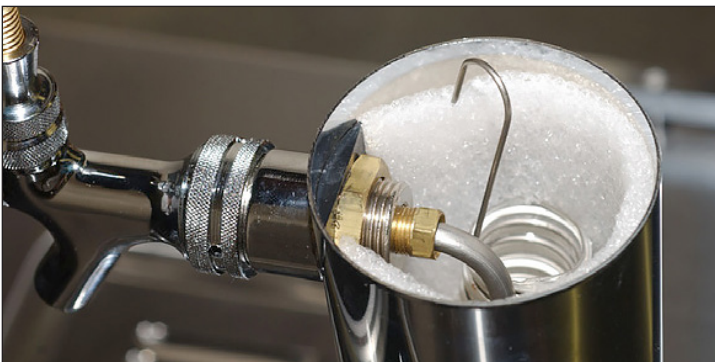
Fig. 8. Accrochez le collier de serrage à froid sur le conduit de bière.
