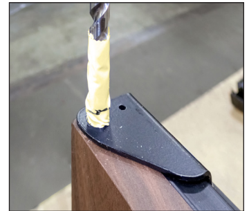
Fig. 9. Percez d'abord le trou de 3/8". ENSUITE, percez le trou de 17/64".
