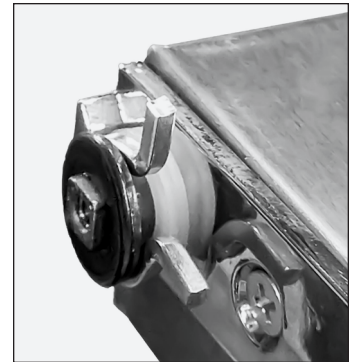
Fig. 7. Mantenga las arandelas en su orden original.
