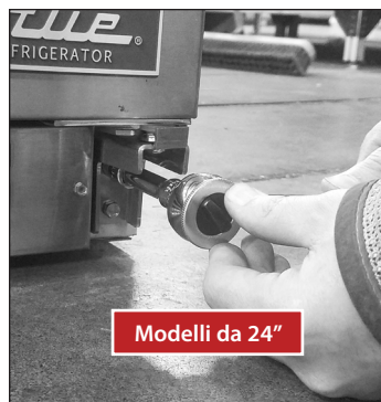
Fig. 1 I modelli 24 e 27 utilizzano cardini inferiori diversi.
