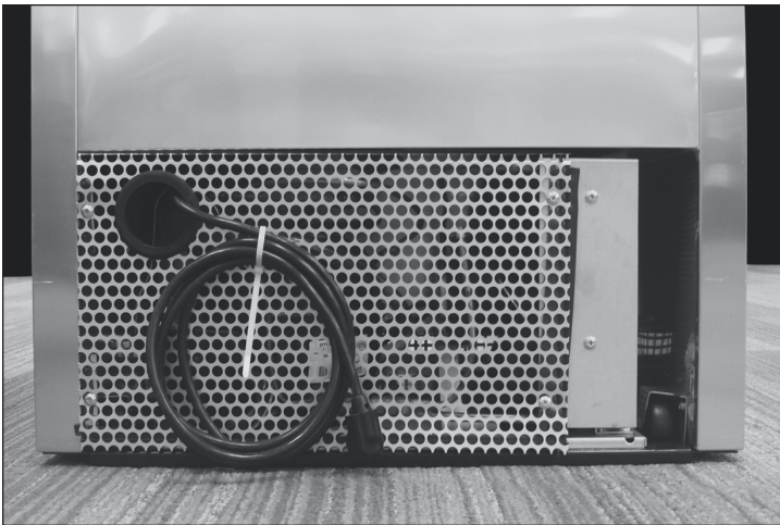
Fig. 1 Griglia situata sul retro dell'elettrodomestico.
