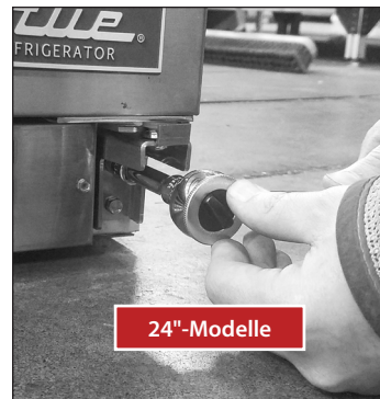
Abb. 1. Die Modelle 24 und 27 verwenden unterschiedliche untere Scharniere.
