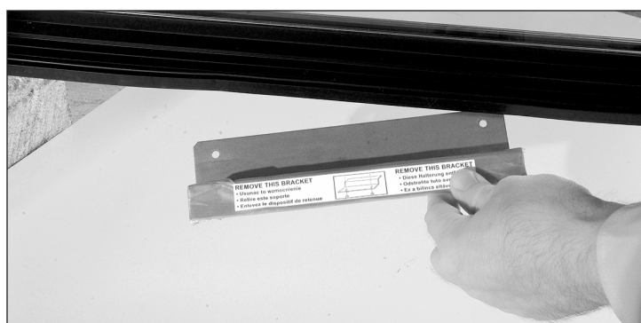
Afb. 2. Verwijder de transportbeugel van de glazen zwenkdeur, indien aanwezig. Niet weggooien.
