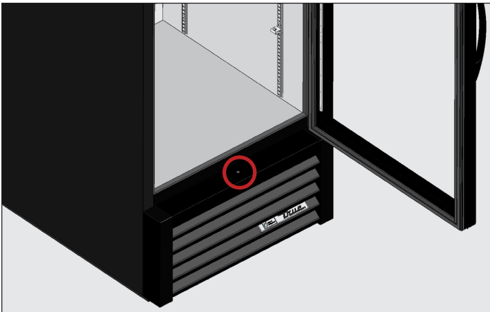
Afb. 1. Locatie van de schroeven op het rooster van de schuifdeur.
