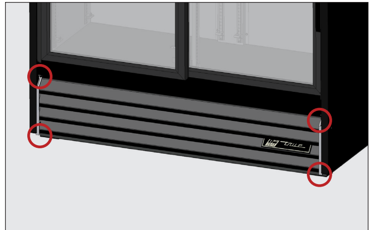
Afb. 2. Locatie van de schroeven op het rooster van de schuifdeur.
