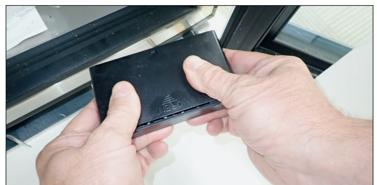
Fig. 5. Retrait du couvercle de la batterie en le faisant coulisser.
