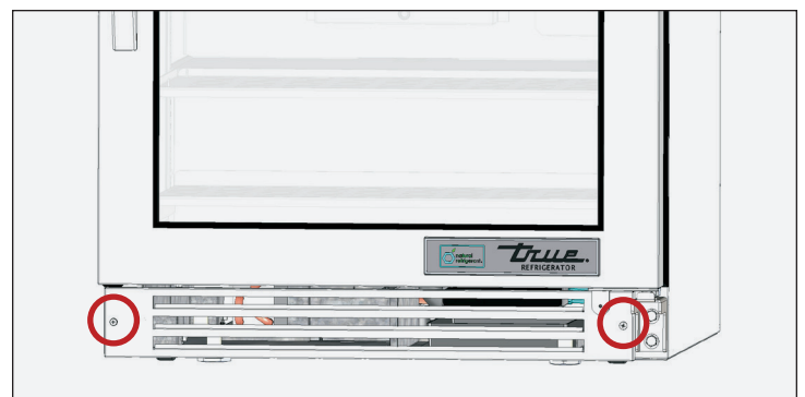
Fig. 2. Emplacements des vis de la grille de ventilation avant sous comptoir.
