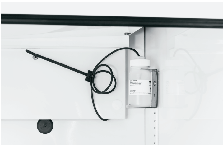
Fig. 3. TRUE recommande de poser le bidon de glycol en haut de l'installation standard de l'étagère arrière droite comme indiqué dans l'illustration. Support de bidon de glycol monté avec une vis standard existante des étagères. À la verticale.
