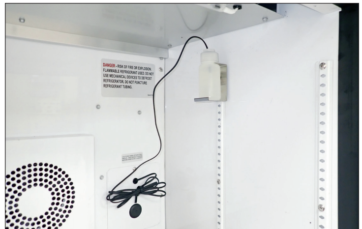
Fig. 4. TRUE recommande de poser le bidon de glycol en haut de l'installation standard de l'étagère arrière droite comme indiqué dans l'illustration. Support de bidon de glycol monté avec une vis standard existante des étagères. Sous comptoir.
