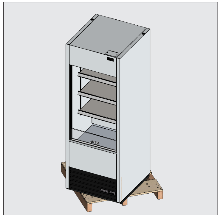
Abb. 3. Verwenden Sie beim Hochheben des Geräts keine Arbeitsplatten, Türen/Schubladen oder Gitter als Hebepunkte.
