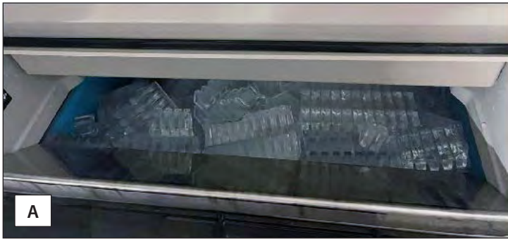
Fig. 5. Depósitos de hielo con (A) y sin (B) deflector de zona de caída.
