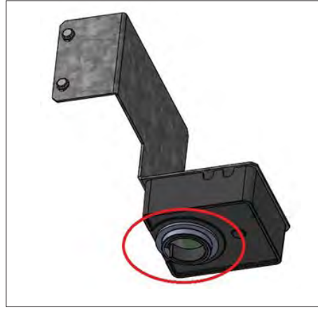
Fig. 2. Ubicación de la lente del sensor de nivel de hielo.
