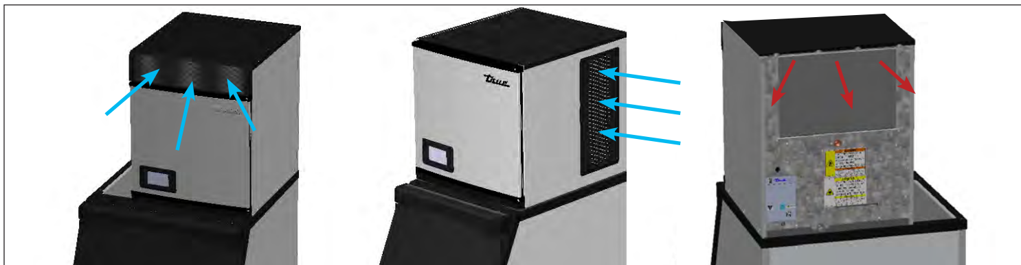
Рис. 2. Воздух поступает спереди/по бокам и выходит сзади.
