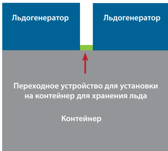
Рис. 2. Льдогенераторы установлены с обеих сторон бункера.
