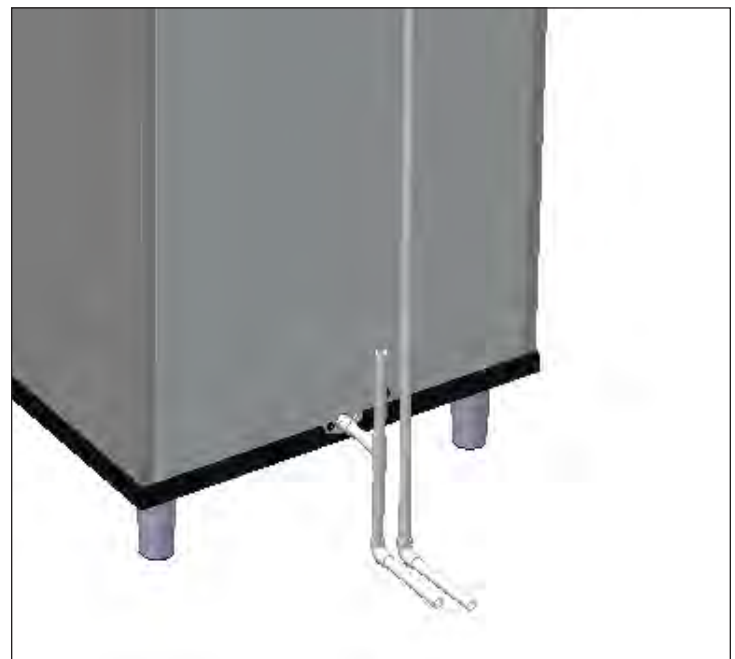
Рис. 2. Пример подключения к водопроводу снизу. Условия применения вашего устройства могут отличаться.
