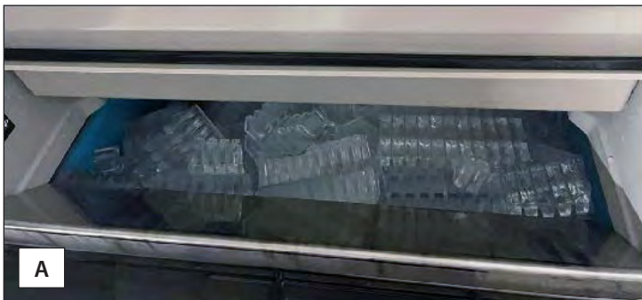
Рис. 5. Контейнер для хранения льда с дефлектором (А) и без дефлектора (В) зоны выдачи льда.
