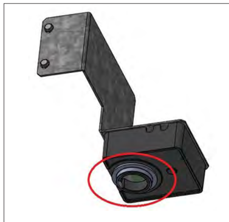
Рис. 2. Место установки линзы датчика уровня льда.
