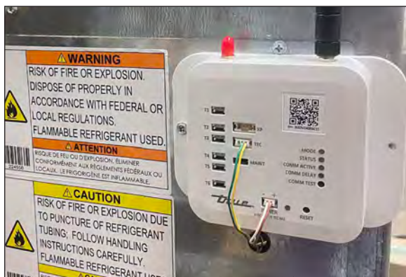
Rys. 2. Wiązka modemu podłączona do modemu. Zielony/żółty do TEC; brązowy/biały do ZASILANIA.
