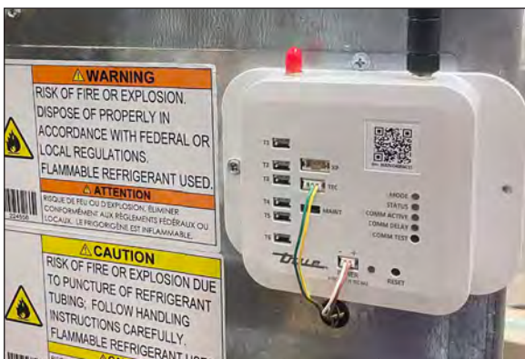
Afb. 2. Kabelboom aangesloten op modem. Groen/geel naar TEC; bruin/wit naar POWER (voeding).
