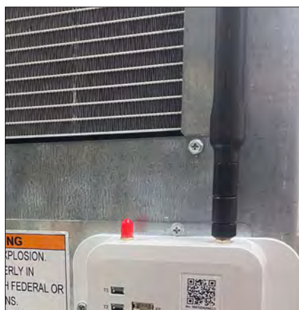
Afb. 3. Antenne op modem geïnstalleerd. Uw antenne kan afwijken.
