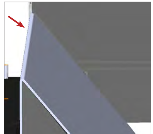
Afb. 4. Zijaanzicht met deflector voor afgiftezone aangebracht.
