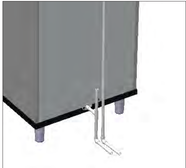
Abb. 2. Beispiel für Rohrleitungsanschluss unten. Ihre Anwendung kann sich unterscheiden.
