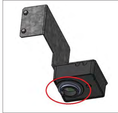
Abb. 2. Ort der Linse des Eisfüllstandsensors.
