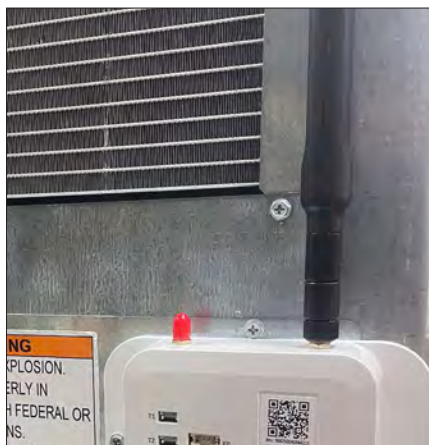
Fig. 3. Antenne installée sur le modem. Votre antenne peut être différente.
