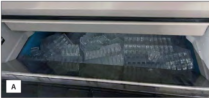
Fig. 5. Bacs à glaçons avec (A) et sans (B) déflecteur de zone de dépôt.
