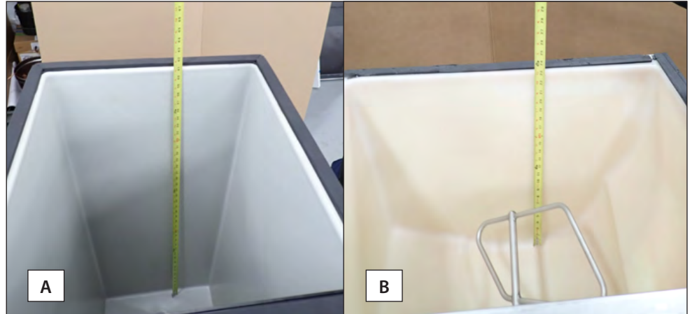
Fig. 2. Mesurez toujours le bac (A) ou le distributeur (B) par rapport au capteur de niveau de glaçons avant le montage sur la machine à glaçons.
