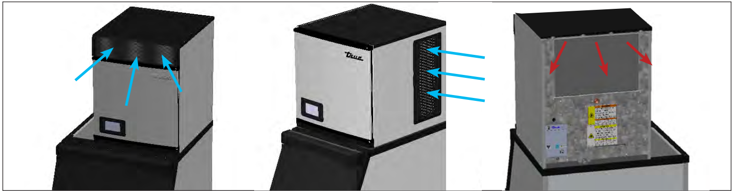
الشكل 2. يتدفق الهواء إلى الأمام/ الجوانب ويخرج من الخلف.
