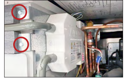
الشكل 3. عرض جانبي لنظام TRUEZONE للأشعة فوق البنفسجية. أماكن براغي حامل TRUEZONE.
