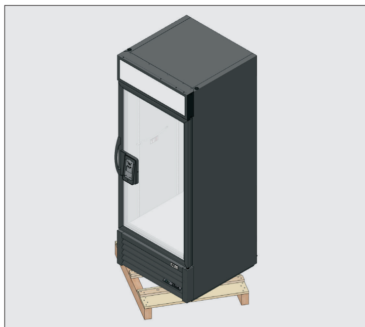
Rys. 4. Podczas podnoszenia urządzenia nie należy wykorzystywać blatów, drzwi/szuflad ani krutek jako punktu podnoszenia.
