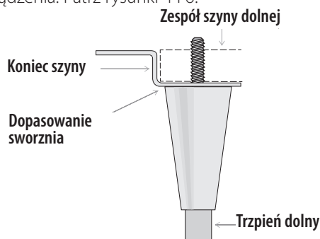
Rys. 4. Schemat budowy nogi poziomującej.
