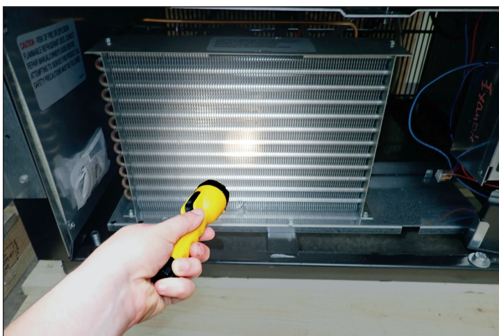
Rys. 3. Sprawdzić, czy wszystkie zatory zostały usunięte.
