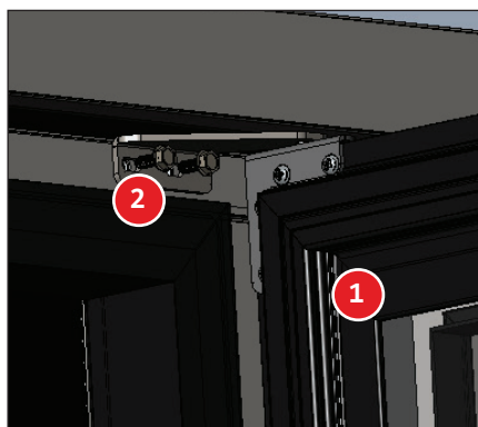
Fig. 10. Instale la bisagra superior y la puerta.
