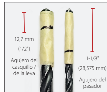
Fig. 8. Marque la profundidad de los agujeros en las brocas.
