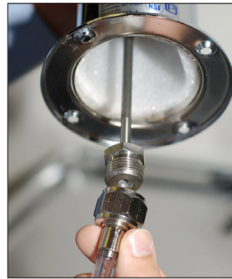
Fig. 3. Conecte el conector del conducto de cerveza a la torre de tiro.
