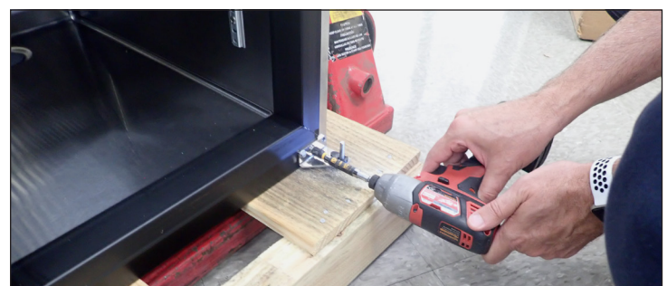
Fig. 7. Instale la bisagra inferior en el lado opuesto de la abertura de la puerta.
