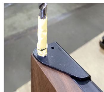
Рис. 9. Сначала просверлите отверстие 3/8". ЗАТЕМ просверлите отверстие 17/64".
