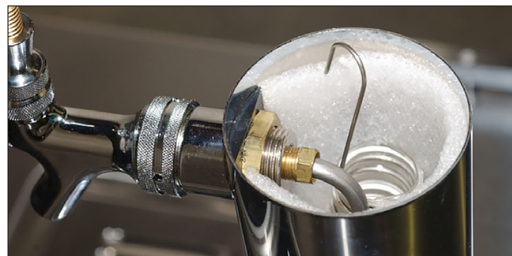
Рис. 8. Закрепите скобу охлаждающего шланга над линией подачи пива.
