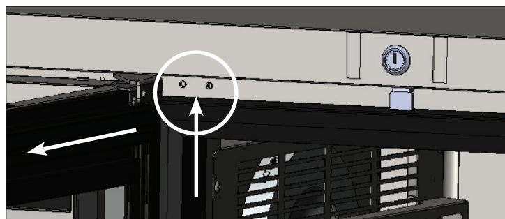
Рис. 2. Демонтируйте верхнюю петлю с устройства.
