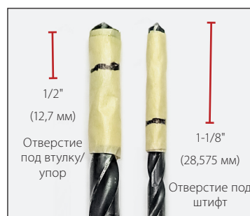
Рис. 8. Обозначьте глубину отверстий на сверлах.
