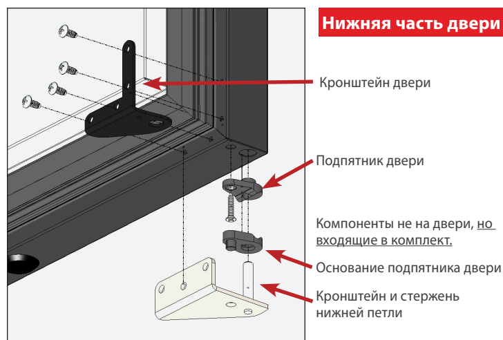
Рис. 4б. Компоненты нижней петли.
