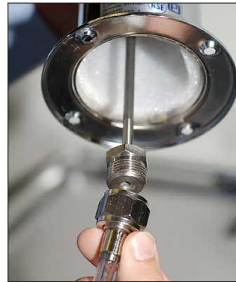
Fig. 3. Collegare il connettore della linea della birra al braccio di trazione.
