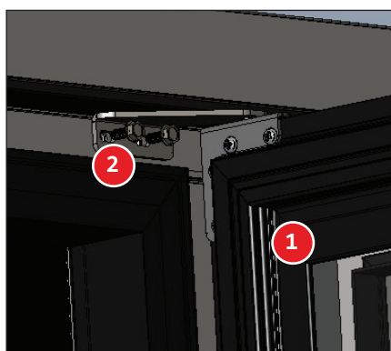
Fig. 10. Installare la cerniera superiore e lo sportello.
