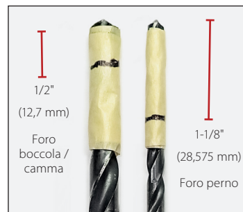
Fig. 8. Contrassegnare le profondità dei fori sulle punte da trapano.
