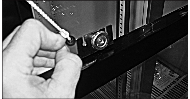
Fig. 6. Fare scorrere la linguetta nera che trattiene il cavo dello sportello fuori dalla parte posteriore.
