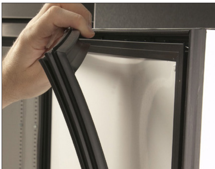
Fig. 2. Tirare la guarnizione partendo da un angolo superiore.
