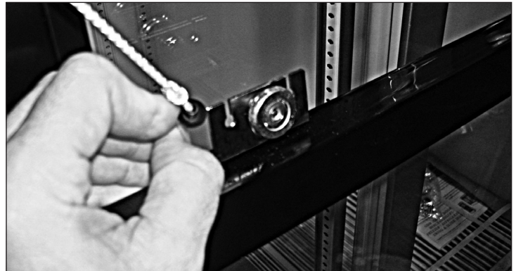
Abb. 6. Den schwarzen Schnurhalter nach hinten aus der Öse schieben.
