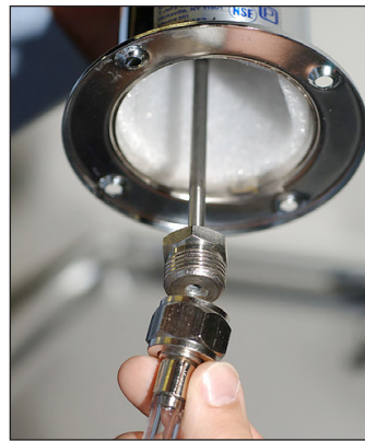
Abb. 3. Anbringen des Bierschlauchanschlusses an der Schanksäule
