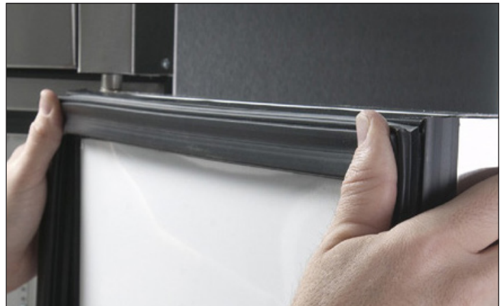
Abb. 4. Üblicherweise tritt um die Türdichtung Silikon hervor. Dies zeigt, dass ausreichend Silikon aufgetragen wurde.
