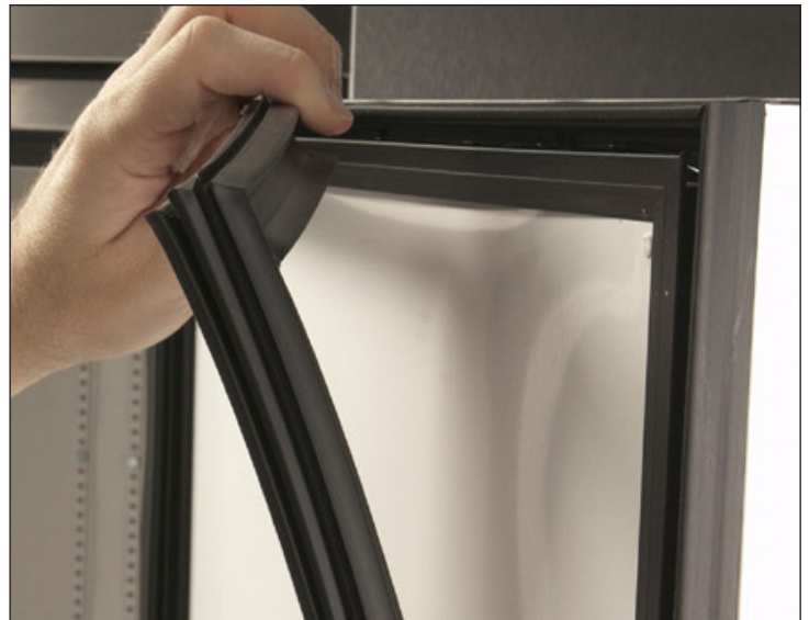
Abb. 2. Türdichtung abziehen, beginnend an einer der oberen Ecken.
