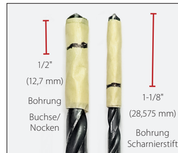
Abb. 8. Die Bohrtiefe an den Bohrern markieren.
