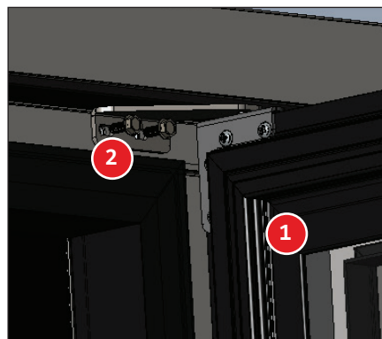
Abb. 10. Oberes Scharnier und die Tür anbringen
