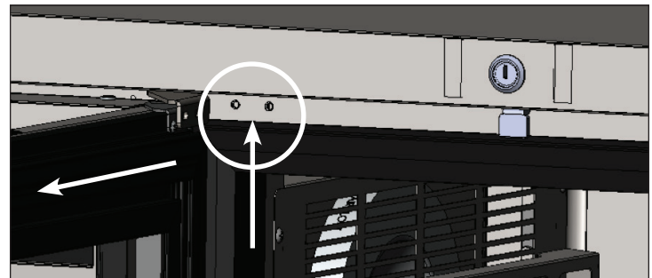
Abb. 2. Oberes Scharnier vom Gerät entfernen
