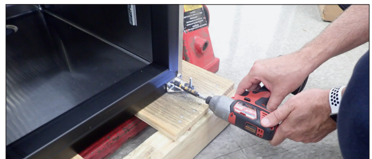
Abb. 7. Das untere Scharnier gegenüber der Türöffnungsseite anbringen.
