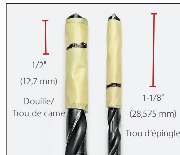
Fig. 8. Marquez la profondeur des trous sur les mèches.
