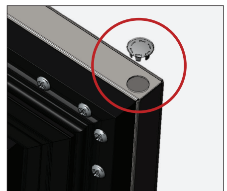
Fig. 11. Installez le cache.
