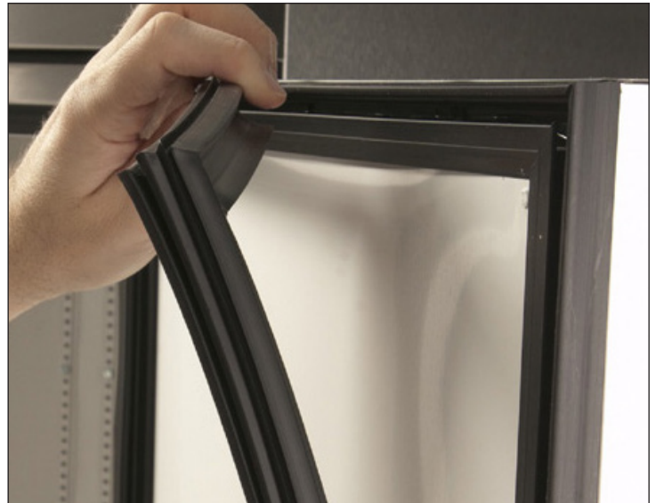
Fig. 2. Tirez sur le joint en commençant par un coin supérieur.
