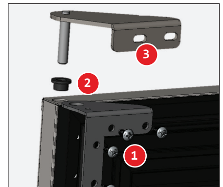
Fig. 7b. Ensemble de composants de charnière supérieure.
