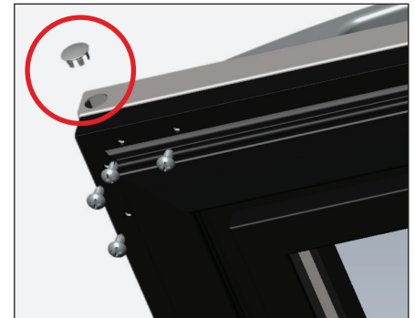
Afb. 6. Verwijder de deurpluggen en resterende schroeven.
