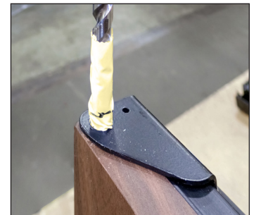
Afb. 9. Boor eerst het 3/8"-gat. Boor DAARNA het 17/64"-gat.
