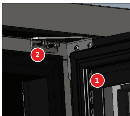
Afb. 10. Installeer het bovenste scharnier en de deur.
