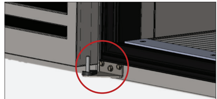
Afb. 3. Til de deur van het onderste scharnier.
