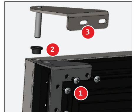
Afb. 7b. Montage onderdelen bovenste scharnier
