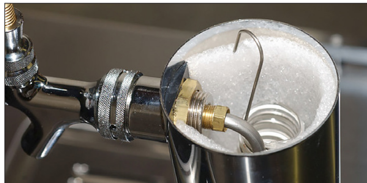
Afb. 8. Hang de koelsinglangklem over de bierleiding.
