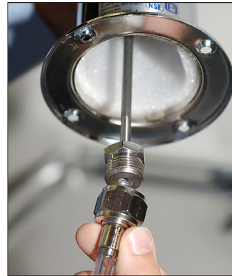
Afb. 3. Bevestig de aansluiting van de bierleiding aan de tapzuil.
