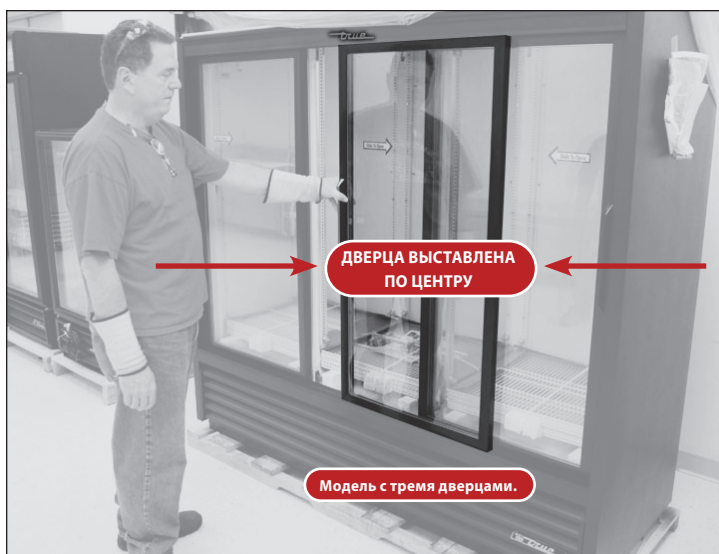
Рис. 3. Расположить среднюю дверцу таким образом, чтобы ее центр приходился на левый край правой дверцы.
