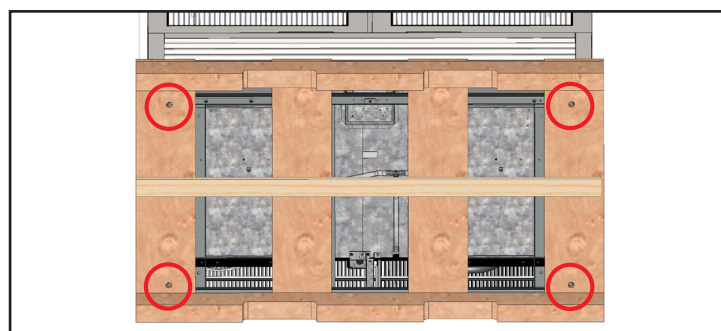
Рис. 4. Местонахождение транспортировочных болтов.
