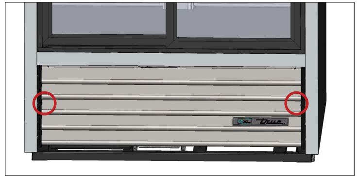
Рис. 2. Винты крепления жалюзийной решетки под раздвижными дверцами
