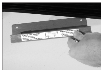
Рис. 2. Снять транспортировочную скобу, фиксирующую стеклянную распашную дверцу (если предусмотрена). Не выбрасывать.
