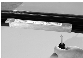
Рис. 2. Снять транспортировочную скобу, фиксирующую стеклянную распашную дверцу (если предусмотрена). Не выбрасывать.
