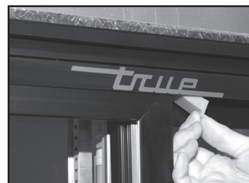
Rys. 3 Lokalizacja bloczków transportowych drzwi przesuwnych. Usunąć, jeśli są w wyposażeniu, ale nie wyrzucać.
