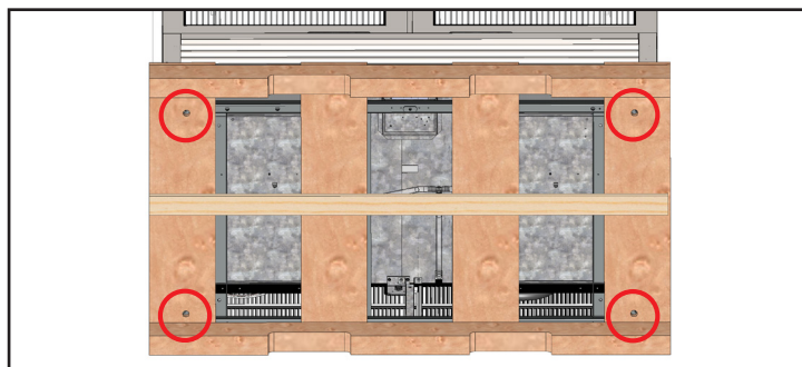
Rys. 4 Lokalizacja śrub transportowych.
