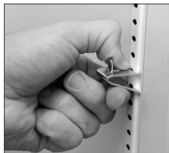
Rys. 3 W trakcie wkładania zacisku może być konieczne jego ściśnięcie lub obrócenie.
