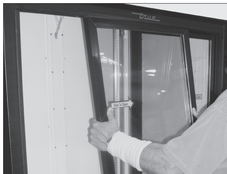
Rys. 4 Ostrożnie wyjąć drzwi.
