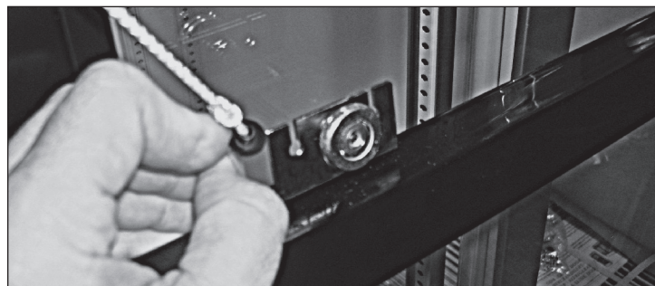
Rys. 8 Wysunąć z tyłu wspornika rolki czarny, plastikowy występ przytrzymujący linkę drzwiową
