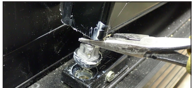
Fig. 7. Ayudante levantando la barra de torsión del orificio maestro de torsión mientras el técnico levanta la puerta.
