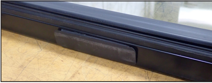
Fig. 11. Cubierta de cables situada en el centro del lado de las bisagras de la puerta.
