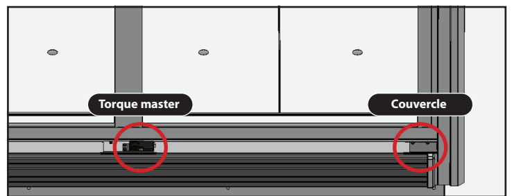
Fig. 18. Emplacements d'origine de l'ensemble torque master et du couvercle.
