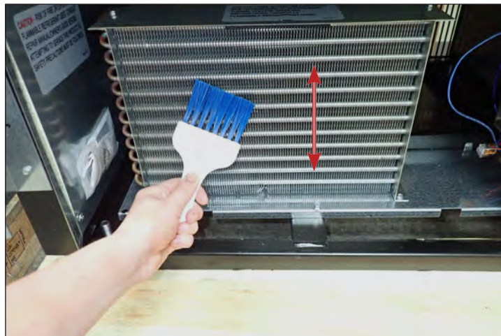
Fig. 2. Ne brossez jamais en travers des ailettes du serpent.
