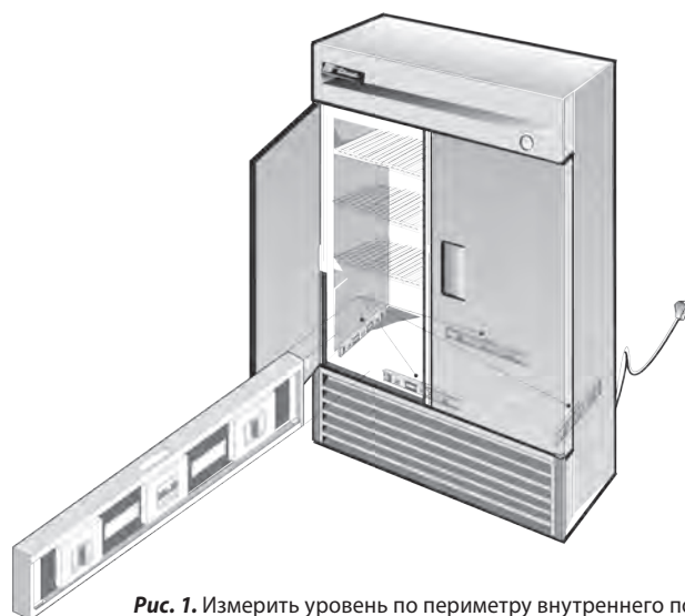
Рис. 1. Измерить уровень по периметру внутреннего пола.
