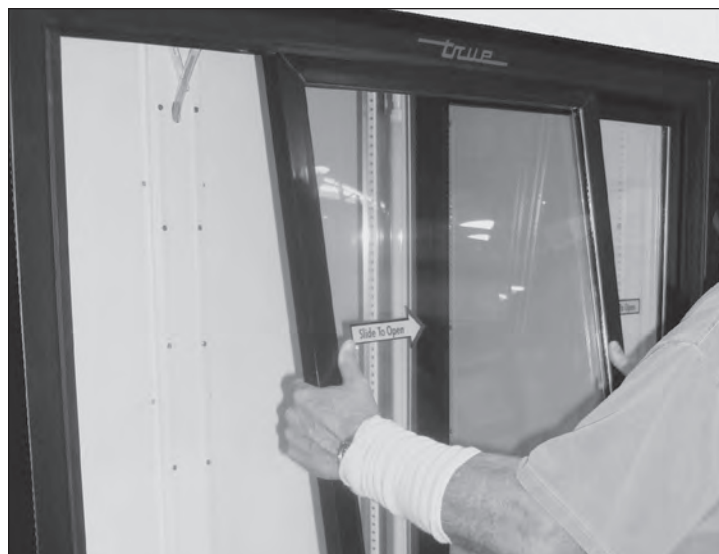
Рис. 4. Осторожно снять дверцу.
