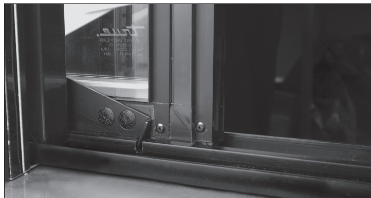
Рис. 1. Защелка дверцы в открытом положении (зафиксирована в пазу)
