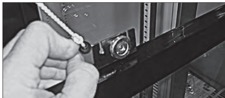
Рис. 8. Выдвинуть черный пластмассовый наконечник тросика из задней части кронштейна ролика.
