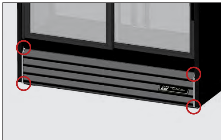
Рис. 2. Винты крепления жалюзийной решетки под раздвижными дверцами
