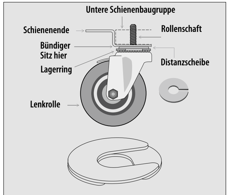
Abb. 4. Schaftrolle und Unterlegscheiben. Setzen Sie mehrere Unterlegscheiben versetzt ein.
