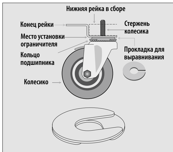
Рис. 4. Колесико и прокладки для основания. Монтируйте несколько прокладок со смещением отверстий.
