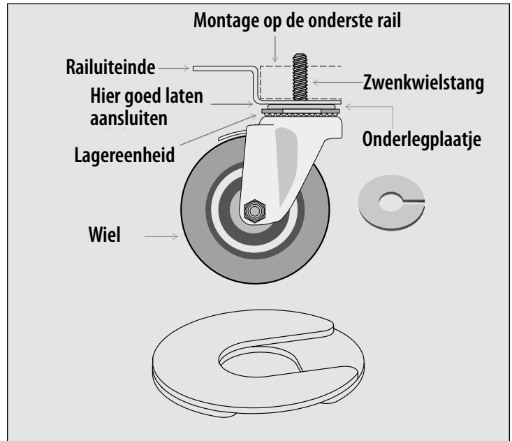
Afb. 4. Wiel met stang en onderlegplaatjes. Installeer meerdere onderlegplaatjes met verspringende sleuven.
