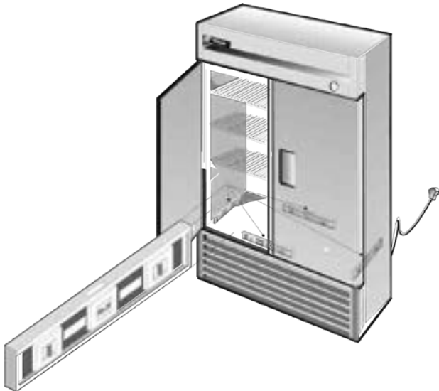
Fig. 1. Comprobación del nivel en todo el perímetro del suelo interior.
