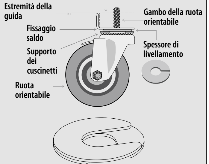
Fig. 4. Gambo ruota orientabili e spessori. Installare più spessori con le fessure di compensazione.
