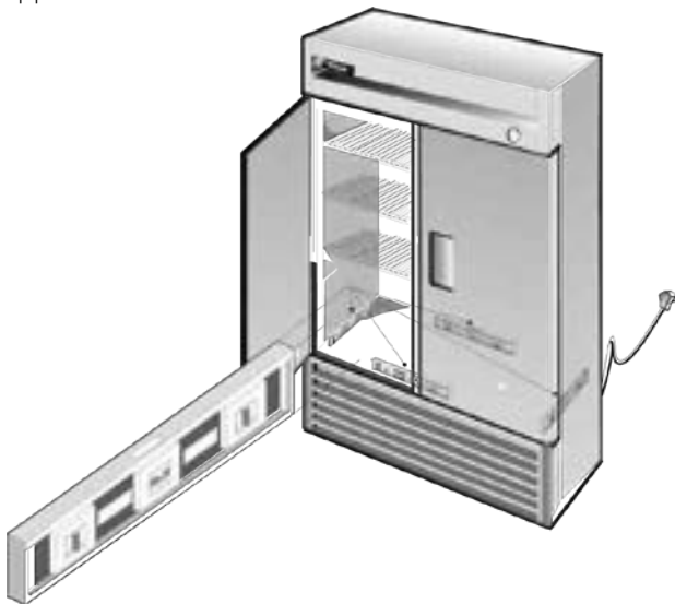
Fig. 1. Mesurez le niveau le long du périmètre du plancher intérieur.
