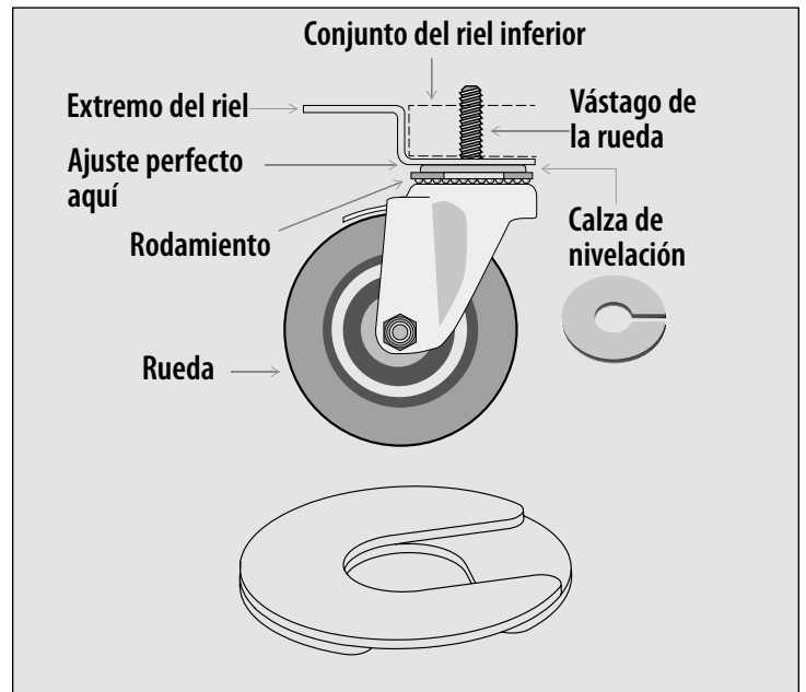
Fig. 4. Rueda con vástago y cuñas. Instalar varios calzos con ranuras de desplazamiento.
